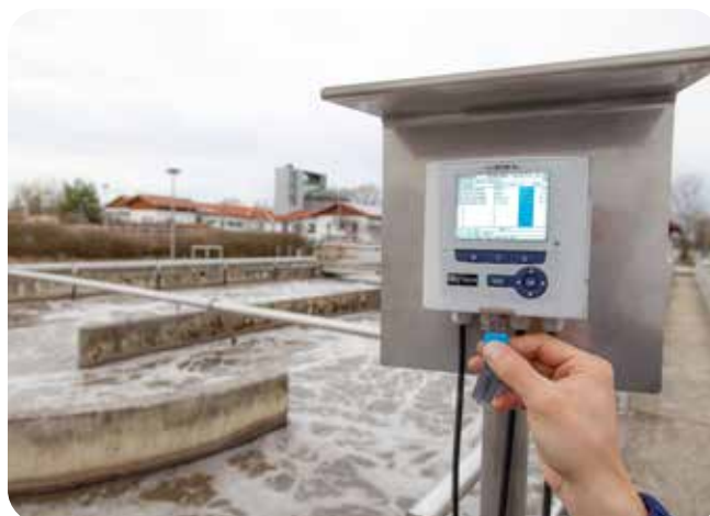
System 282/284 mit standardmäßiger USB-Schnittstellen und integriertem Datenspeicher
